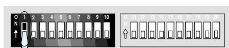
Chiusura automatica attivata Automatic closure enabled Fermeture automatique activé Schließautomatik zugeschaltet Cierre automático activado
